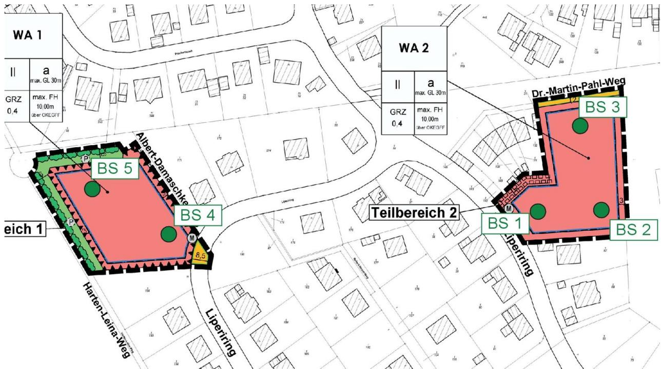
Abbildung 11 - Auszug aus dem Lageplan der Baugrunderkundung, Übersicht der Rammkernsondierbohrpunkte
